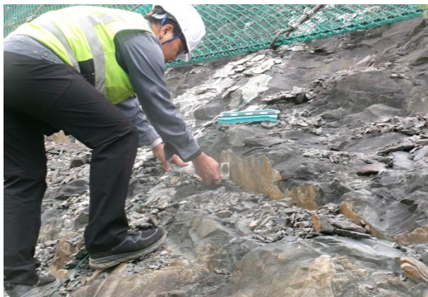
절리면 경사/경사방향 측정
